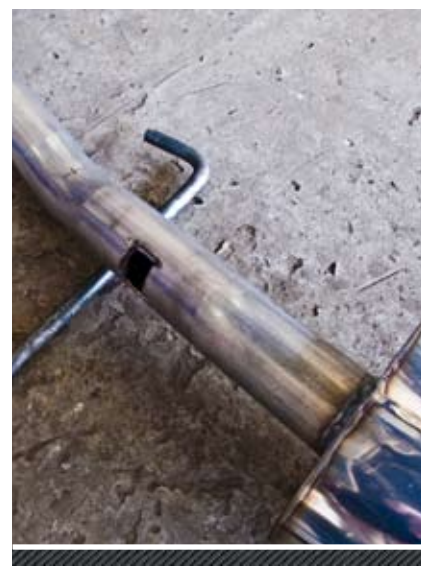
[9] Перед тем как все окончательно закрепить, вырезаем отверстие под лямбда-зонд.
