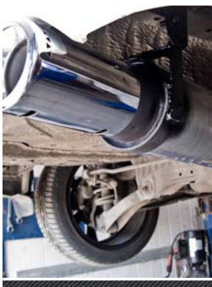
[14] Устанавливаем выпуск на заранее подготовленные места.
