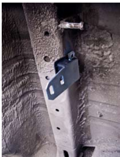
[7] Устанавливаем крепления на кузов (крепления идут в комплекте с глушителем).
