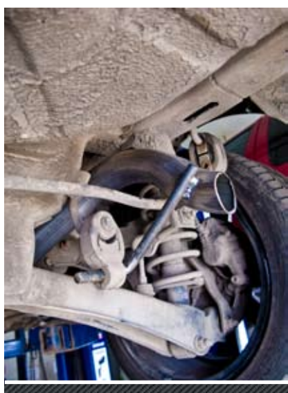
[13] Собираем систему, окончательно свариваем.
